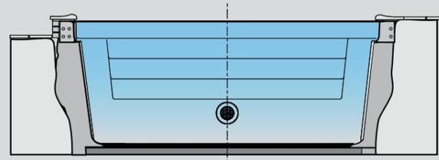
Einbau auf Bodenplatte. Variante für Freibäder.
