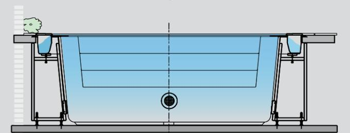
Einbau freitragend mit Überlaufrinne: Wandverstreben aus Stahl.
